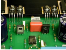
Stadio d'ingresso professionale in classe A. Stadio driver ultralineare in classe A
