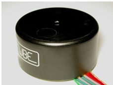
2 trasformatori da 50 VA rispettivamente per la sezione digitale e per quella analogica (integrati negli alimentatori esterni)
