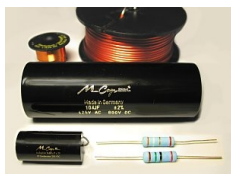
Crossover : uso di condensatori ad alta precisione MKP, resistenze a film metallico a bassissima tolleranza, induttanze avvolte in aria a bassissima distorsione.
