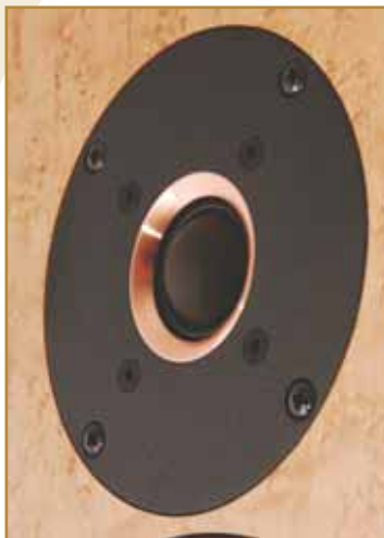
Particolare del Tweeter con magnete in neodimio.
