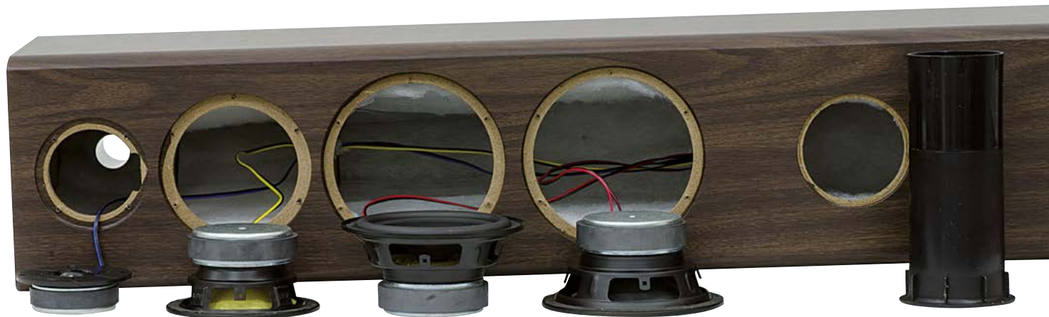
Il diffusore completamente smontato. Notiamo il tweeter con il magnete in ferrite, il bel midrange con la classica membrana gialla ed i due woofer col cestello in lamiera stampata ma dalla distorsione estremamente contenuta.
